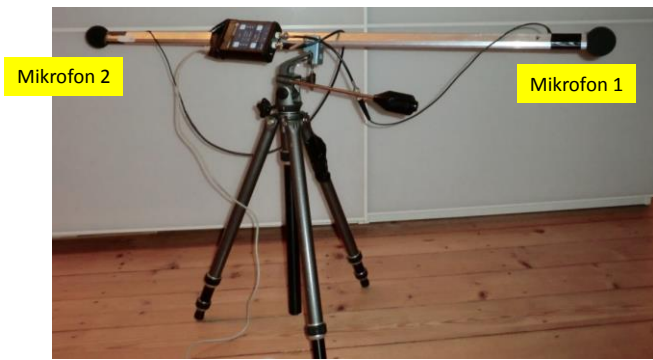
Abbildung 2: Zwei-Mikrofon-Array aus ¼“ICP-Mikrofonen und ROGA-USB Soundkarte.
